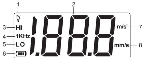
1. : 背光灯指示，测量中7秒后无任何操作背光灯关闭。
