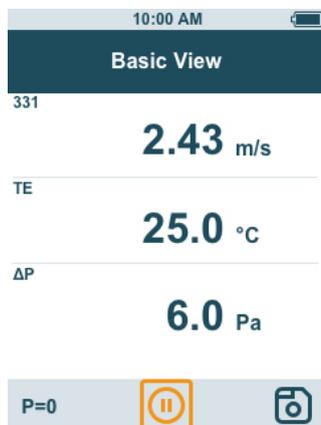
可以根据连接的探头设置测量参数，例如单个值的可见性或单位。
